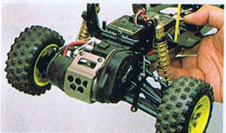
▲ リヤ・ダンパーステーは厚手のFRPプレートで作り直されている
