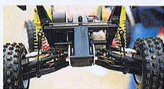
⑪サス・ストロークも十分。いかにも効率のよさそうなジョイントに注目
