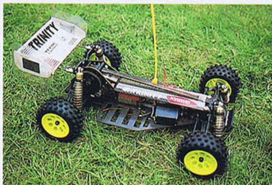
④ダンパースターの前にFRPプレートでボディマウントを新設
