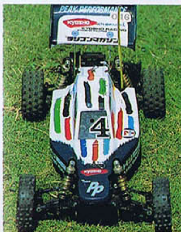
おなじみ、ベネトン・カラーで装った小泉車。フロント・スタビが取りはずされている
