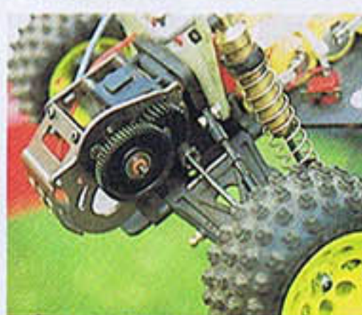
⑤リヤのダンパースターもFRPプレートに変更
